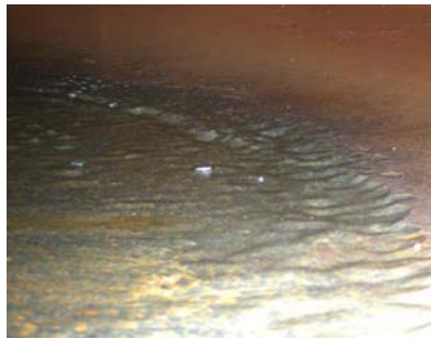
Corrosion Fulgurante d'un Réacteur d'oxydation de soude usée
